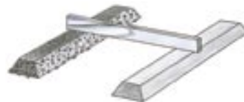
Die parallelen Estrichstreifen mit einer Waaglatte abziehen.
