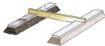
Liaporfitstreifen mit Waaglatten: in den Zwischenraum eingefülltes Liaporfit mit Waaglatte abziehen.
