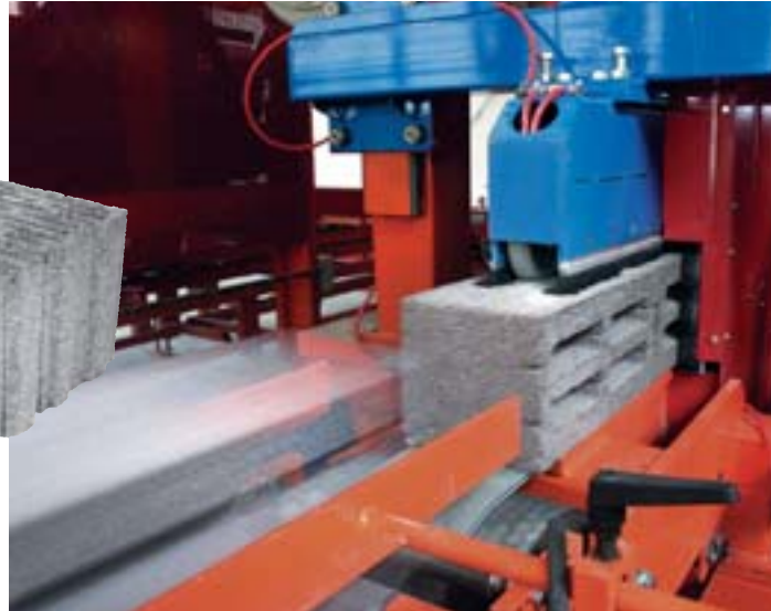
Vollautomatisierte Anlage zum Planfräsen von Mauersteinen.
