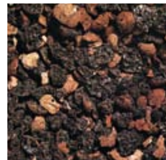
Ein Schutzvlies trennt die im Mittel rund 15 Zentimeter mächtige Liadrain-Schicht von der darüberliegenden Substratschicht.
