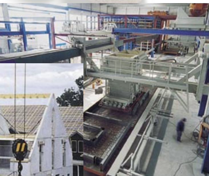
Fertigungsanlagen wie die bei der Kaspar Röckelein KG bieten Festigkeitsklassen von LAC 2 bis LAC 25.
