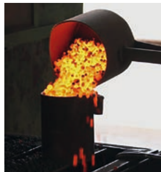
Nah dran: die gerade gebrannten Liapor-Blähton-Kugeln.
