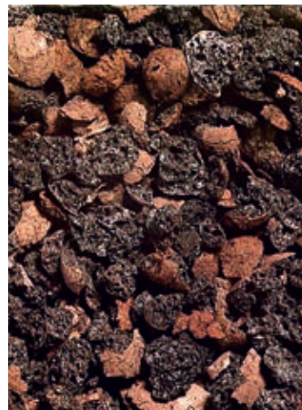
Das gebrochene Blähton-Granulat ist leicht, stabil und benötigt keinen weiteren Schichtaufbau.
