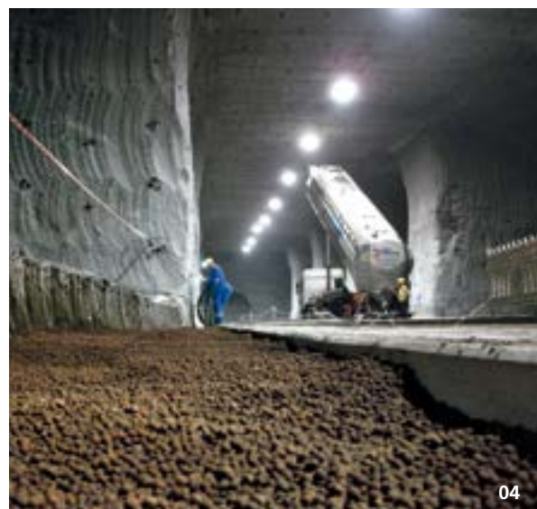
04 Das Schüttgut kann auch per Schlauchleitung direkt eingeleitet werden, wie hier im Salzbergwerk Stetten.
