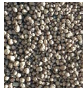
Hohe Formstabilität bei geringem Gewicht sind Charakteristika der Blähtonkörnung.
