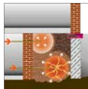
Nach der Hohlraumverfüllung mit Liapor (oben) erfolgt die Injektion des Expansionsharzes, das sich ausdehnt (unten).
